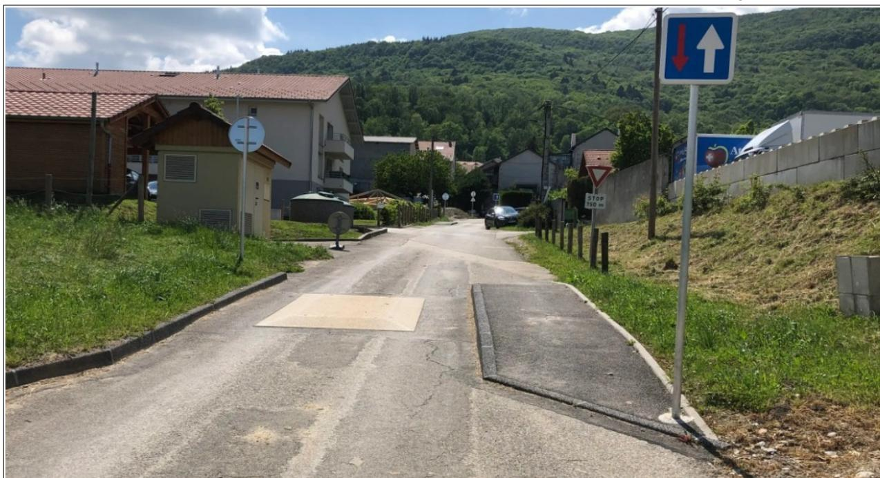
*Exemple d'association d'un coussin et d'une écluse simple*
